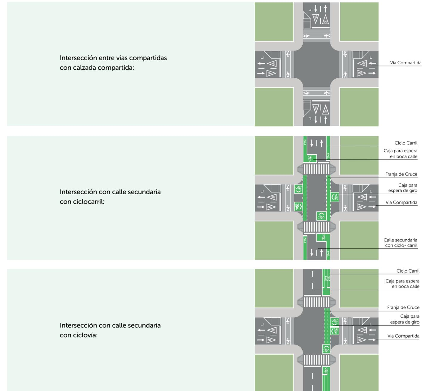
Ilustración 45. Tipos de intersecciones en calles terciarias.
