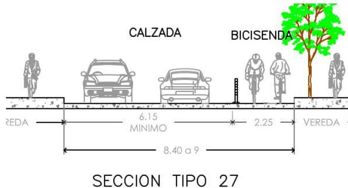
En este caso el ancho de la vía que se destina a la nueva infraestructura ciclista, incluyendo los elementos de segregación del resto del tránsito tiene una anchura de 2,25 m de los cuales 0,5 m forman la banda de segregación. El resto, 1,75 m incluyen una pequeña separación del cordón de vereda de 0,15 m (en ocasiones sirve de cuneta) y una banda de rodadura efectiva de 1,6 m.
